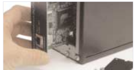
Les cartes de gestion d'APC peuvent être insérées dans la SmartSlot intégrée pour permettre le contrôle des conditions d'alimentation. Les unités Smart-UPS RT 5000, 7500 et 10 000 sont livrées avec la carte de gestion Web/SNMP
