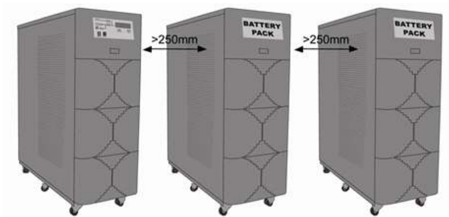
Figure 3b : Placement onduleur avec armoires batteries
