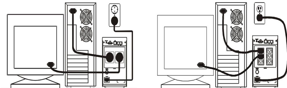
Attention: Ne pas connecter d'imprimante laser sur les prises de sortie car la puissance de l'onduleur n'est pas adaptée à ce type d'équipement.
