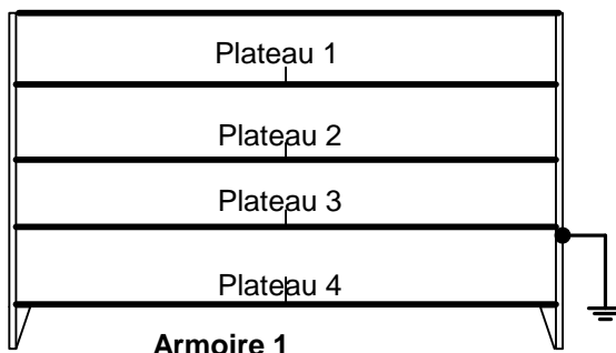
Disposition des batteries :
